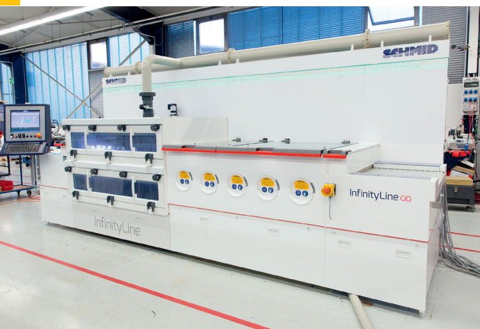
Nassprozessanlage mit Ätzmodul der Schmid Group: Die Entwicklung der neuen Modullinie InfinityLine basiert auf den Vorgängerlinien CombiLine und PremiumLine
