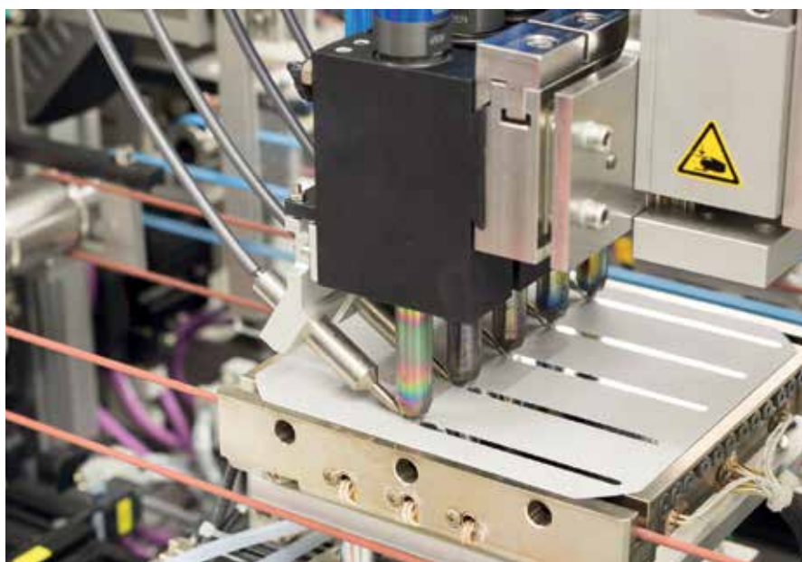
锡母线取代银母线：选择使用SCHMID集团的TinPad系统，就能降低太阳能电池的生产成本
