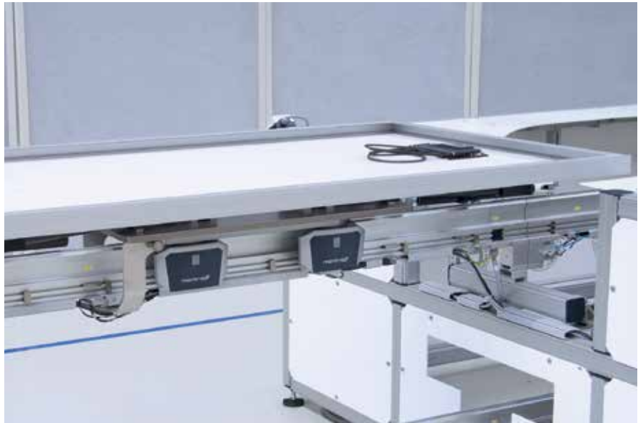
平稳的单轨小车为太阳能组件的运输提供无障碍、无震动的条件
