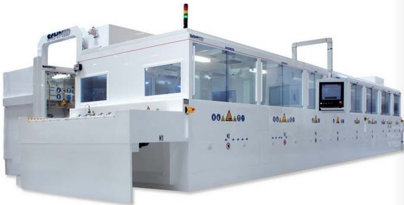
SCHMID的碱边缘隔离设备是世界上唯一无需使用硝酸 (HNO3) 的设备
